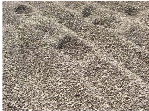
写真-5.4 試料の天日乾燥(右)と加圧脱水浄水汚泥(左)
