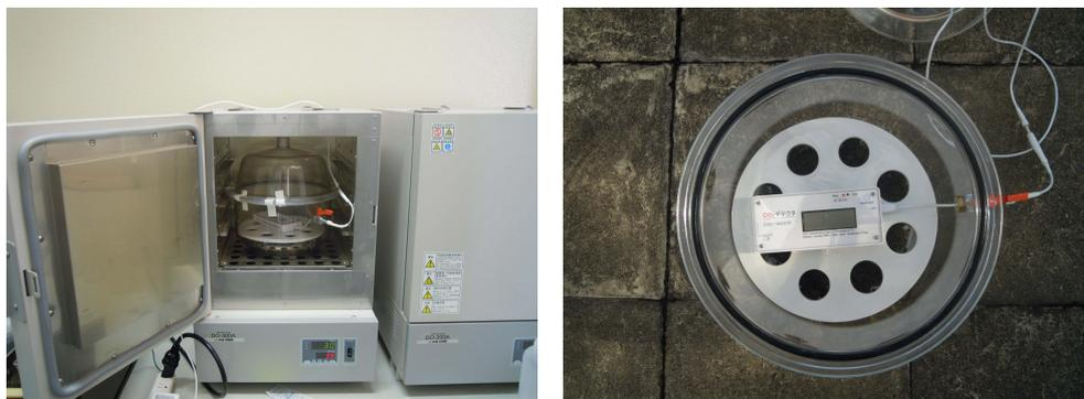
写真-5.1 恒温・好気性環境における浄水汚泥の二酸化炭素排出量測定の様子
