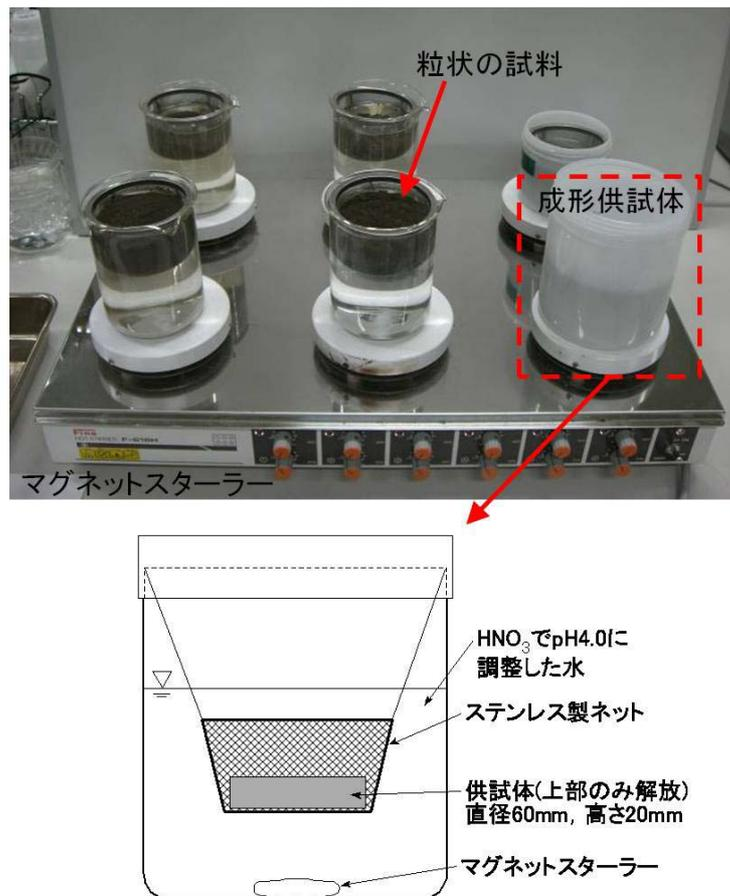
図-5.4 シリアルバッチ試験装置の概要
