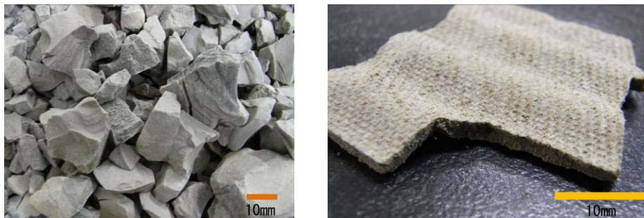
写真-1.1 天日乾燥した浄水汚泥(左)と加圧脱水した浄水汚泥(右)
