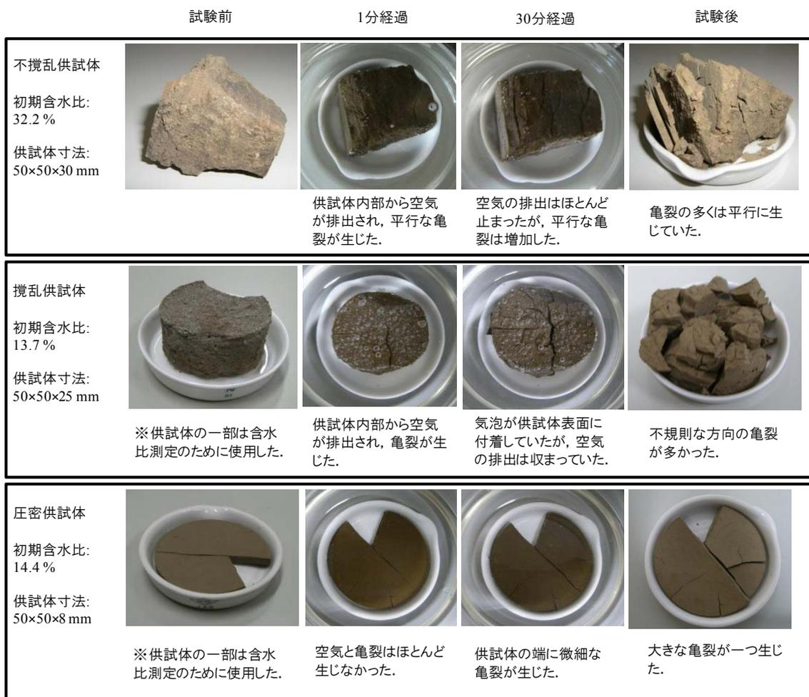
写真-2.7 浄水汚泥(天日乾燥供試体・再構成供試体・圧密後供試体)の促進スレーキング試験結果
