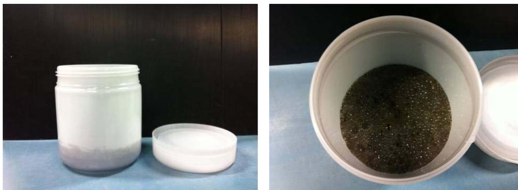
写真-4.1 浸漬容器と過酸化水素水に浄水汚泥を浸漬させた時の様子
