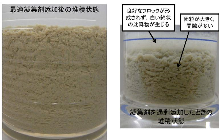
写真-3.5 凝集剤添加量が異なるときの粒子の堆積状態の比較
