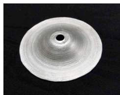
図 10 亜鉛メッキ鋼板の失敗例
