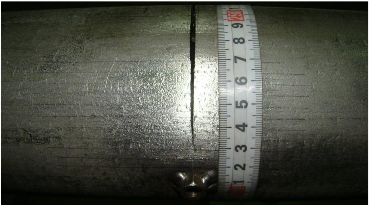
図 5.2-4 SUS316 Case1 き裂部写真
