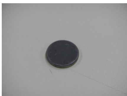
図 3-4 プレスされた \text{Ag}_2\text{O} 粉末
