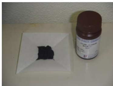
図 3-1 実験に使用した \text{Ag}_2\text{O} 粉末
