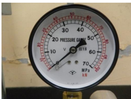
写真.4 エヌピーエーシステム製プレス機表示目盛
