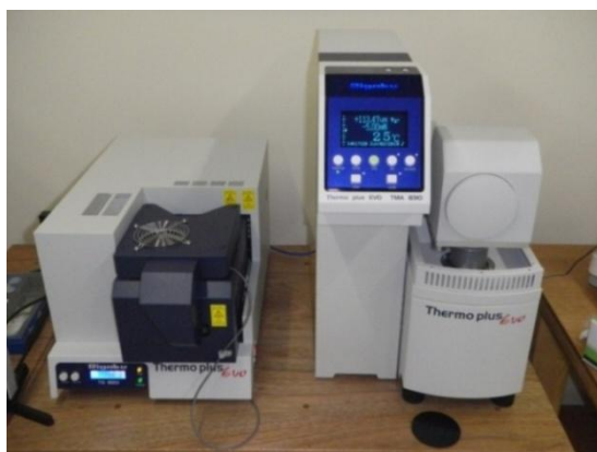
図 3-11 TMA 装置(右側)及び TG(左側)装置
