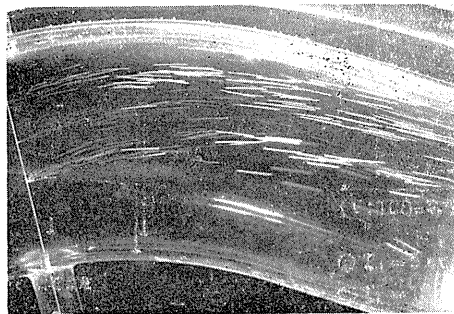
図41 曲管内の流れ撮影例 (曲管B，プローブ位置③)
