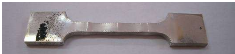
Fig. 3.12 773K にて 20%のひずみを付与した MP-FSP 材の外観
