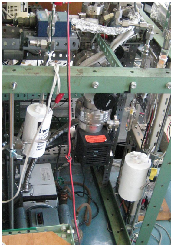
Fig.2.2 トリチウムガスチャージ装置外観
