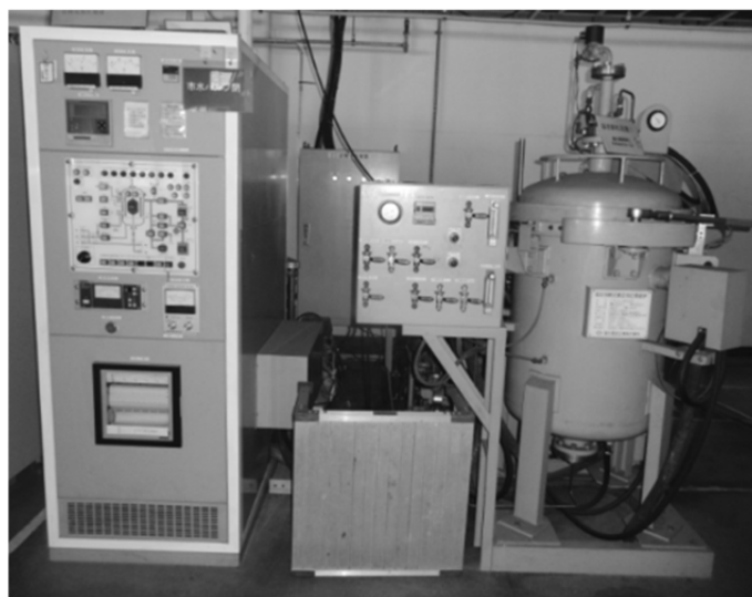
図 3-22 富士電波工業(株)製抵抗加熱式真空加圧焼結炉
