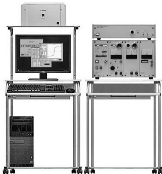
図 3-9 理研電子(株)製直流磁気測定装置 Model BHS-40 (3)
