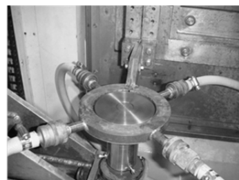
リング試験片と加熱コイルの位置関係
