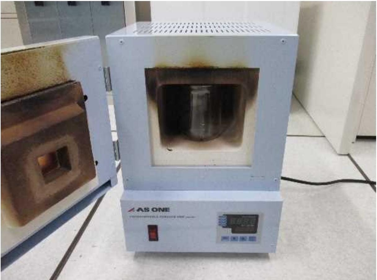
図ー 9 炭化工程に用いた電気炉
