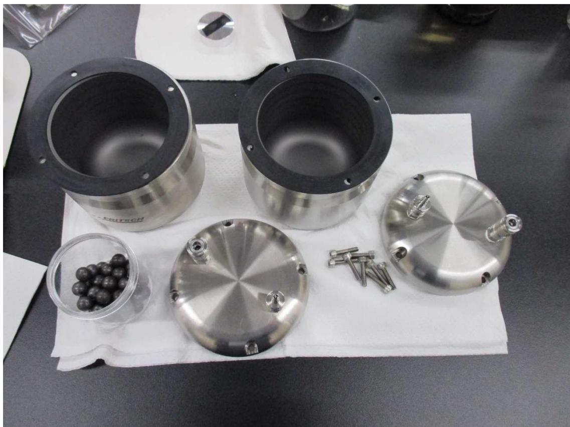
図-14 使用したボールミル容器とタングステン製ボール
