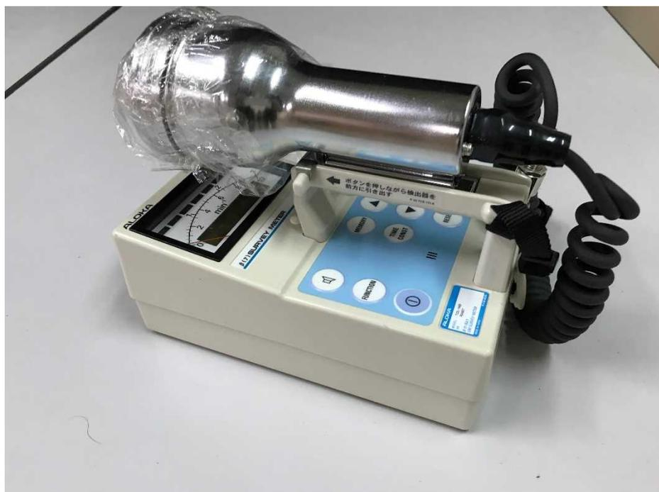
図-5 GM管を用いた測定器
