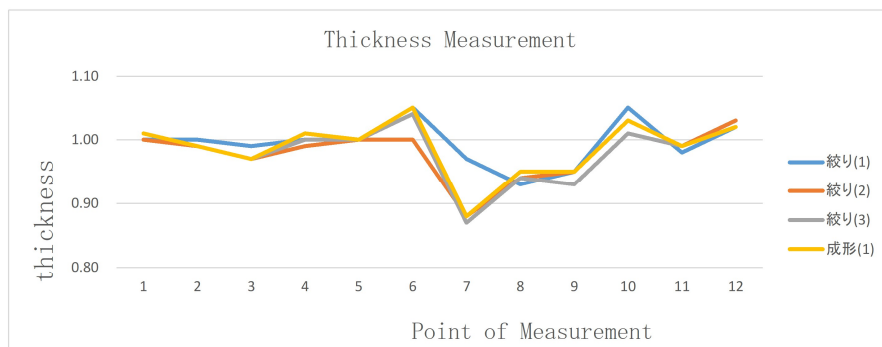
図 4-29 板厚測定結果
