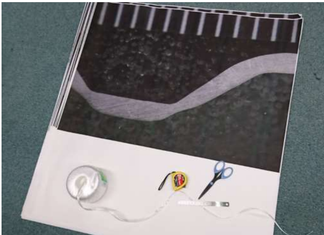
図 2-22 A1 用紙に印刷した試験片
