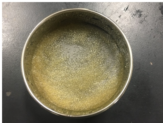
図 3.4.4 ふるいによる活性汚泥と陽イオン交換樹脂の分離：A 回収した活性汚泥；B 分離された陽イオン交換樹脂
