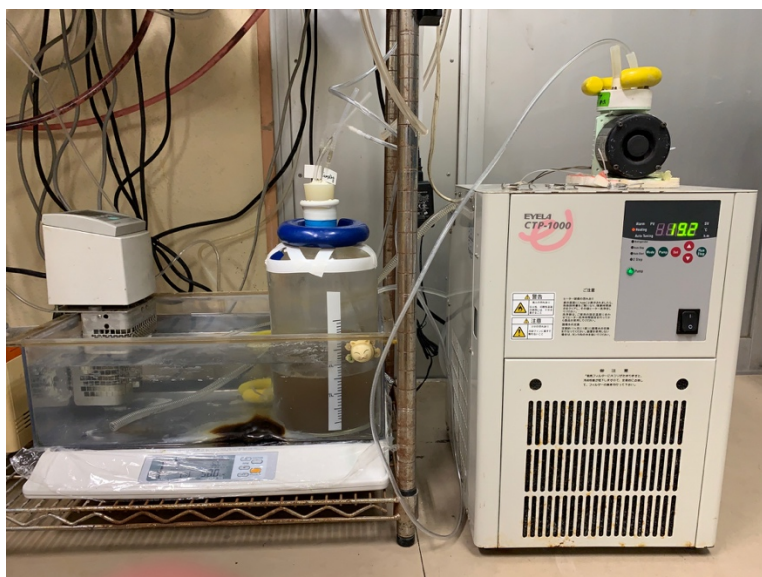
図 3.4.6 嫌気—好気条件における有機物濃度と活性汚泥の ORAC 挙動のバッチ試験
